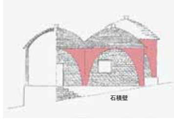
スレート葺、石積構法による恒久化
